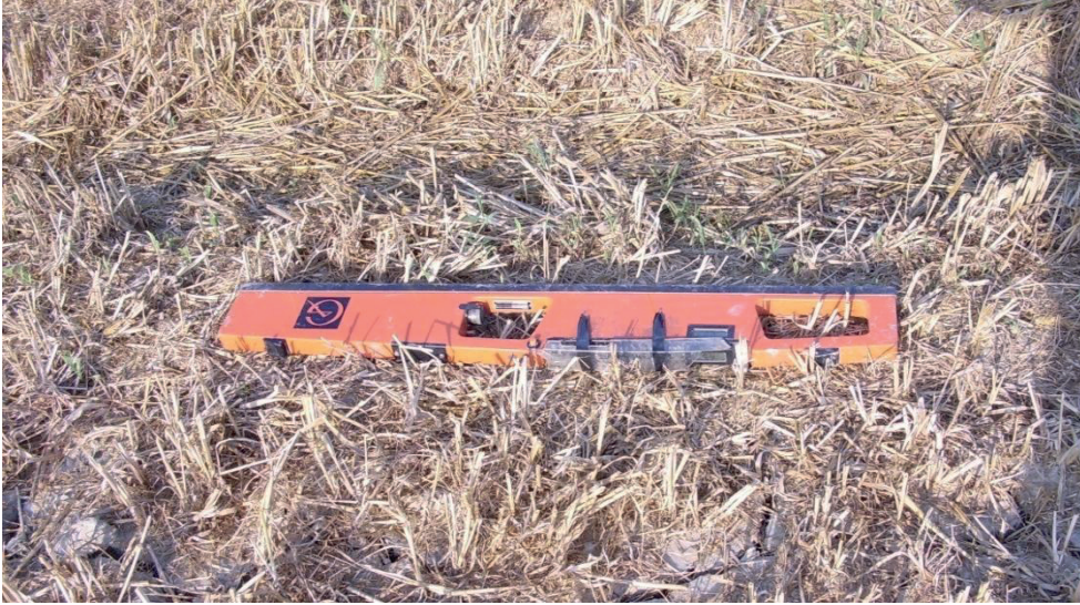
Şekil 1. Arazide, 0-1 m toprak derinliğinde tuzluluk ölçümü için EM38'in yatay kullanımı.
