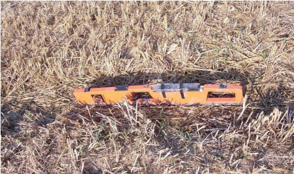
Şekil 2. Arazide, 0-2 m toprak derinliğinde tuzluluk ölçümü için EM38'in düşey kullanımı
